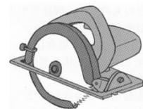
携帯用丸のこ盤については、その携帯性と使い易さから、建設業をはじめ、様々な業種で使用されていますが、安全装置が有効に機能していない状態で使用するなど、誤った方法で使用していることによる災害(死亡災害含)が毎年多数発生しています。
